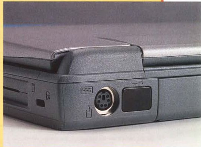
Una doppia porta USB con al lato destro l'uscita SVHS; a sinistra è presente un connettore per tastiera/mouse esterni. Una nota a proposito di quest'ultima porta: è possibile collegare contemporaneamente sia la tastiera, sia il mouse, solo tramite un apposito cavetto ad Y, piuttosto costoso e che non viene quasi mai fornito assieme al portatile.
